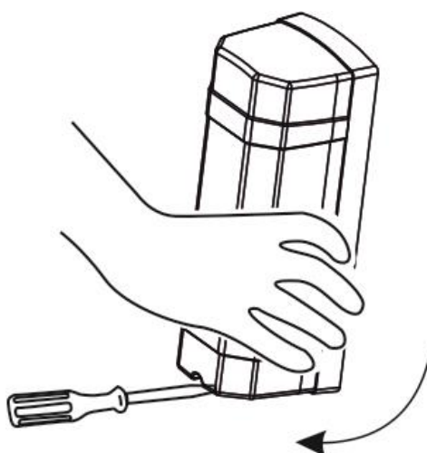
Рисунок 2.8 - Порядок отсоединения крышки от базового основания
